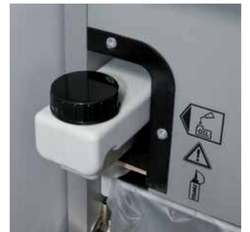
Depósito de aceite integrado para un lubricado automático controlado de los rodillos de corte cruzado que favorece una operatividad más prolongada con un rendimiento constante
