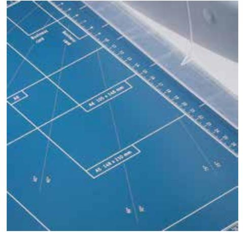
Útiles líneas de formato en la mesa con escala en mm a lo largo del canto de corte facilitan la alineación del material a cortar
